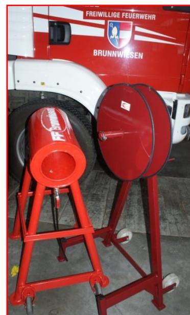
Zwei tolle, praktische, arbeitersparende Geräte für die Reinigung wurden beispielsweise ebenfalls von 2 Kameraden in Eigenregie konstruiert und professionell gebaut. Eine Schlauchwaschmaschine und ein Schlauchwickler der beiden Tüftler Günther Hainitz und Sebastian Babinger erleichtern seit 2014 die Arbeiten nach Einsätzen und Übungen.
